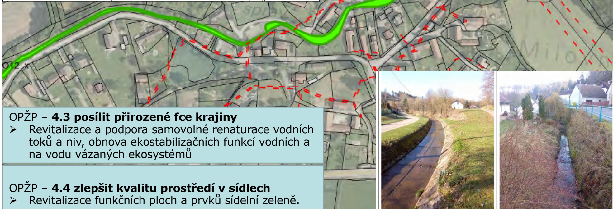
Obrázek 1 V horní části obce je koryto zkapacitněno, napříměno a opevněné ŽB panely.
